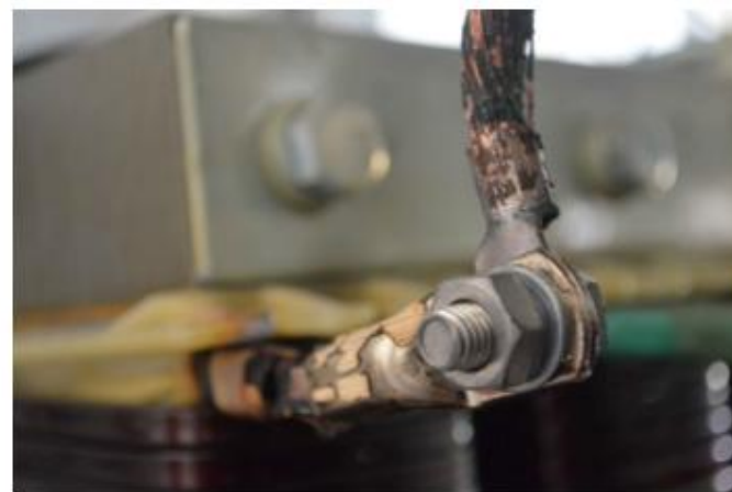
低成本劣质冷压端子（绿色）和路之生选用冷压端子（黄色）
